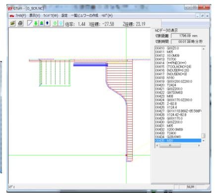
各ツールごとの色や径の設定が出来、描画データと切削距離、切削時間をファイル管理のデータベースに登録します。又各制御メーカーのサブプログラムコードが任意に選択できます。
